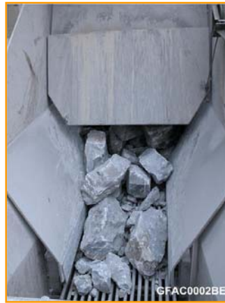
» Material en machacadora del primario
